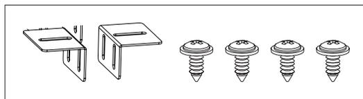
Installez les supports de montage sur le dessus du foyer avec les vis noires fournies.
